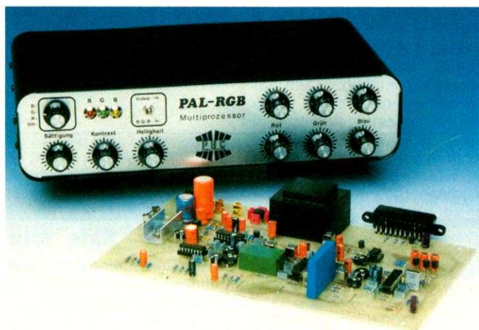
Platine und Gehäuse des PAL-RGB-Multiprozessors, der einen RGB-Splitter, einen Video-Farbprozessor und einen RGB-PAL-Wandler beinhaltet
